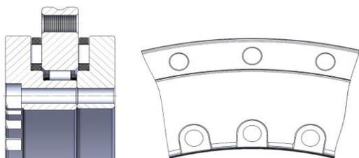
Schraubensenkungen im Innenring zur Lagerbohrung.
